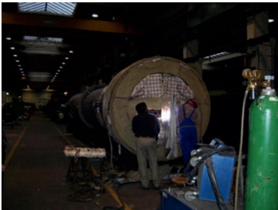
▲ Bild 3. Arbeiten an einem Rohrbündelwärmeaustauscher aus dem Werkstoff 12CrMo9-10
