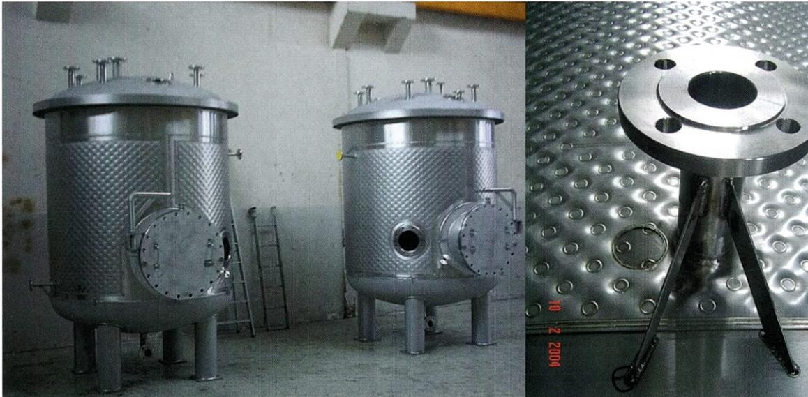
◀ Bild 6. Lagerbehälter mit Pillow-Plate-Beheizung des zylindrischen Teils
